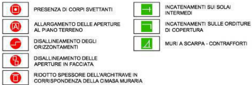
Figura 5.100 Legenda delle vulnerabilità e delle resistenze osservate nel centro storico di Faenza.
